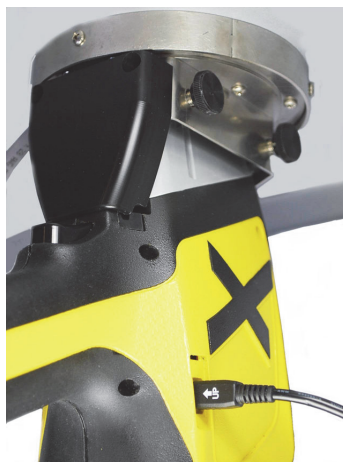
Рис. 5-8 Mini USB B-разъём кабеля, подсоединённый к порту анализатора
