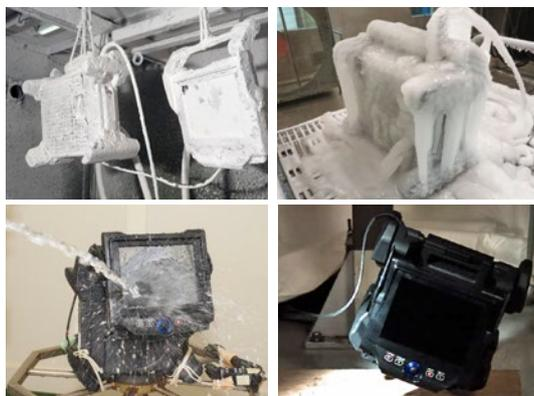
**Надежный и долговечный,** IPLEX NX отвечает требованиям военного стандарта MIL-STD-810G/461F и IP55 (защита от пыли и струй воды). Рабочая часть устойчива к воздействию высоких температур (до 100°C). Это значит, что можно приступать к работе, не дожидаясь полного остывания объекта.
